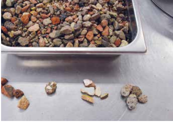
Typische Komponenten für Recycling-Beton (von links nach rechts): Backstein und Ziegel, Terrazzoböden, Keramikplatten und Beton.
