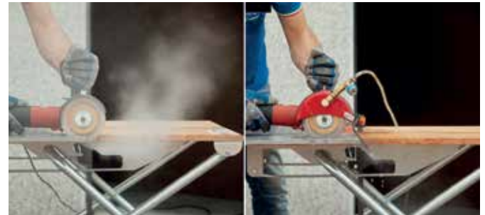
Staubarme Bearbeitung von Keramik und Naturstein mittels Nassfräsen. Bild Montolit
