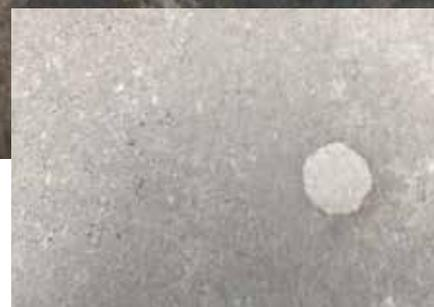
Der helle Fleck auf dem Foto hat einen Durchmesser von 10 mm, ist kein Fleck, sondern wurde so produziert. Wenn eine solche Platte 120/120 cm eingebaut wird, ist die Reklamation garantiert und hier würden sämtliche Gifte ohne Erfolg eingesetzt.
