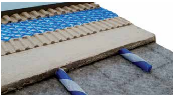
BLANKE PERMATOP SF, hier mit Rohrabstand von 10 cm
