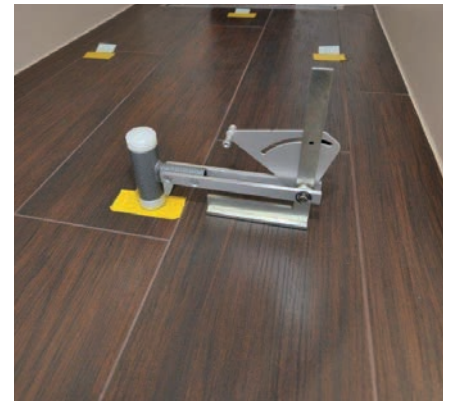
Die Geräuscherzeugung zur Simulation haustechnischer Benutzungsgereusche erfolgt mit dem Pendelfallhammer.
