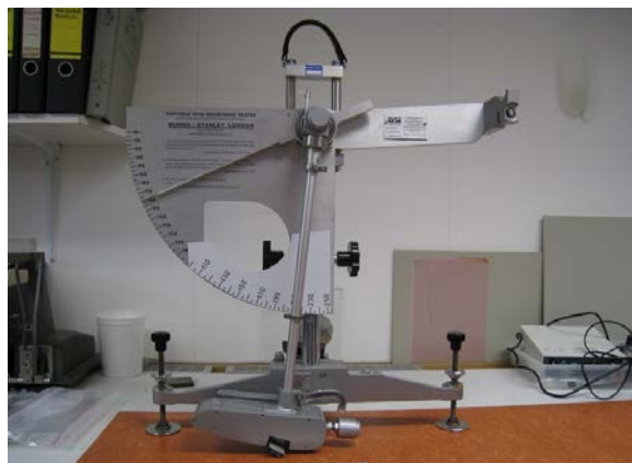
Abbildung 10 British Portable Tester
