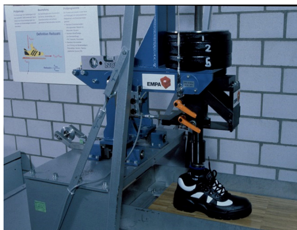
Abbildung 4 Boden- und Schuhtester BST 2000
