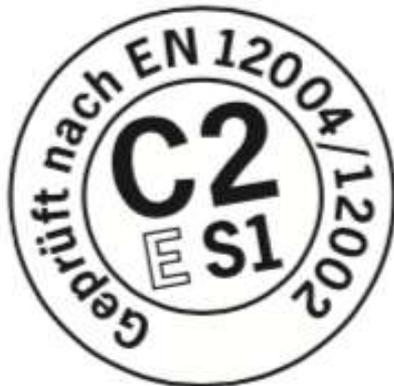
Verlegemörtel mit einer C2 S1- Kennzeichnung sind die Mindestvoraussetzung zur Verlegung großer Formate.
