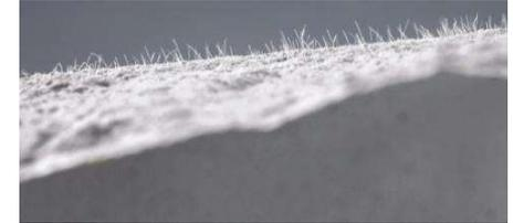
Durch den Einsatz der MICROTEC-Faserarmierung in Dünnbettmörtel wird wie bei Stahlbeton die innere Festigkeit gefördert.
